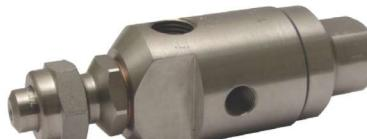
Stesse caratteristiche della pistola PA1. Consente di spruzzare ad intermittenza utilizzando ugelli idraulici modelli C1-CX-DH fino a portate massime di 1,3 Lt/min a 3 Bar (solo liquido senza l'ausilio di aria compressa di miscelazione).
